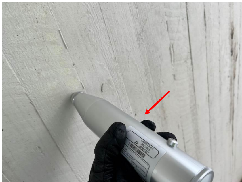
34.att. Betona stiprības mērījums balsta ķermenim (C30/37). Skats uz krasta balstu Nr.1.
