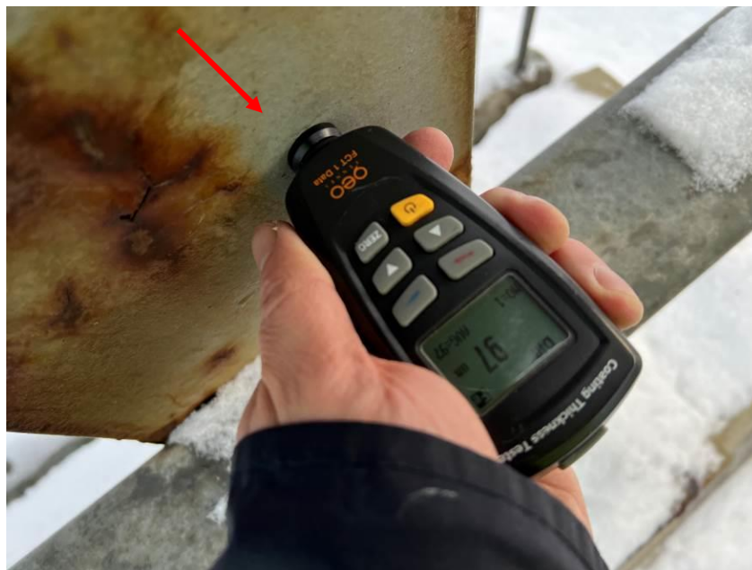
19.att. Barjeras stabiņa krāsojuma kārtas biezuma pārbaude. (97-350mmk) Skats 1.laidumā augšteces pusē.
