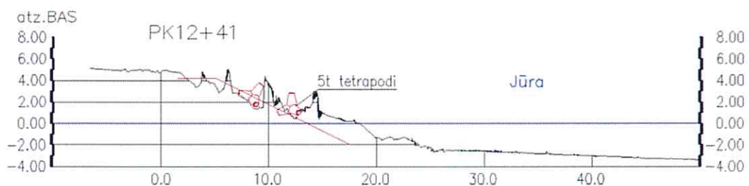
Faktiskais mola šķēsgriezums savietots ar projekta kontūru sarkanā krāsā.
