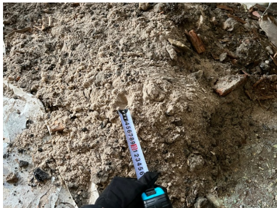
4.1.22.un 4.1.23.att. Veicot atšurfējumus konstatēts, ka grunts veids ir smalka jūras smiltis, ēkas ārpusē konstatēts būvgružu piejaukums.
