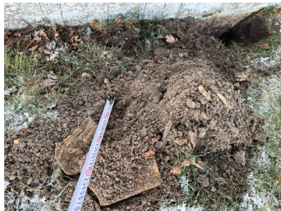
4.1.22.un 4.1.23.att. Veicot atšurfējumus konstatēts, ka grunts veids ir smalka jūras smiltis, ēkas ārpusē konstatēts būvgružu piejaukums.
